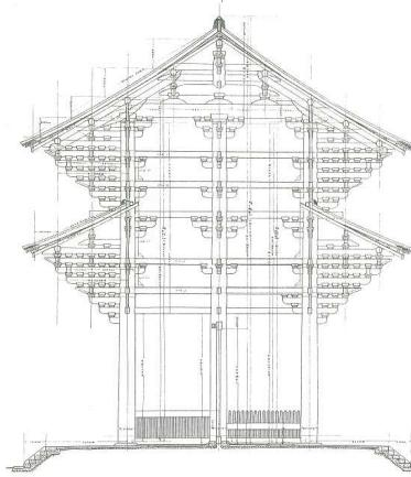
2. 貫ぬきで軸部を水平方向に固め、挿肘木さしひじきを重ねて軒の荷重を支える大仏様の建築物である。
