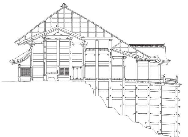
4. 長い束柱つかばしらを貫ぬきで固めた足代によって、急な崖あししろの上に張り出した床を支える懸造かけづくりの建築物である。
