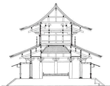
3. 主体部の柱と裳階の柱を海老虹梁えびこうりょうでつなぎ、組物を柱の上のみならず柱と柱の間にも組んで詰組つめぐみとする禅宗様の建築物である。
